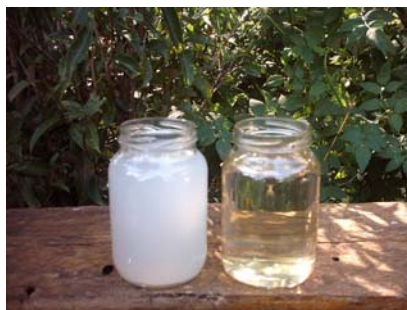
Figura 05: Comparação entre o efluente que entra e o que sai da ETE por zona de raízes, frasco esquerdo efluente bruto e direito efluente tratado.
