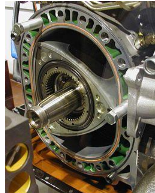
Motor do tipo Wankel, Com adaptação para a Entrada de H 2 na tecnologia HR da Mazda
