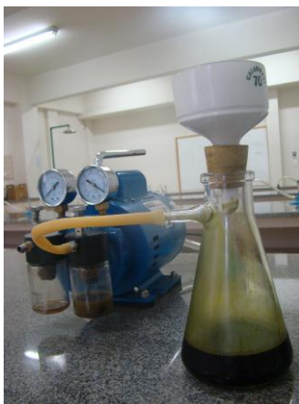
Figura 3 – Processo de filtragem do extrato da planta B. dracunculifolia .
