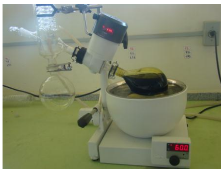
Figura 4 – Processo de evaporação do extrato da planta B. dracunculifolia .
