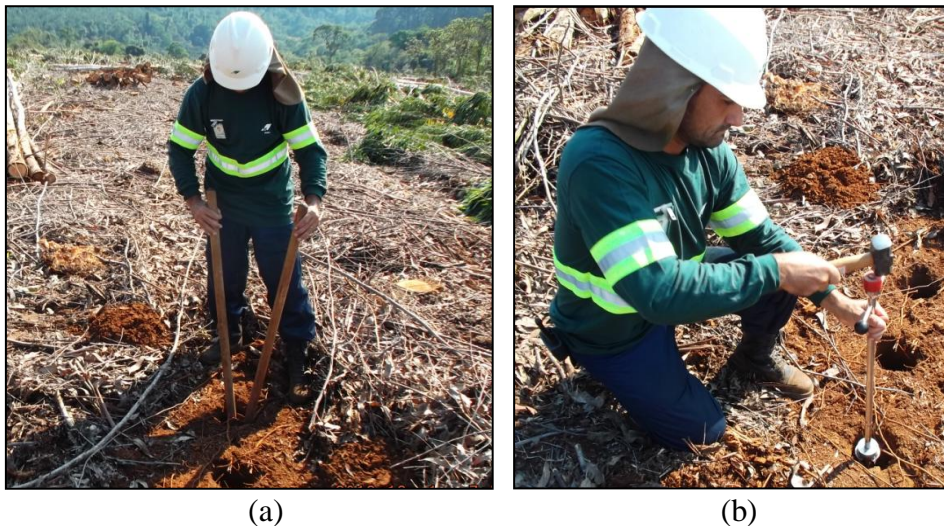
Figura 4. Abertura das covas com uma cavadeira (a) e coleta das amostras com amostrador volumétrico de amostras indeformadas (TAI) em campo (b).
