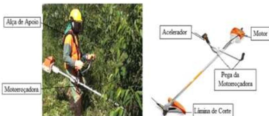
**Figura 4** Roçada semimecanizada, detalhe da motorroçadora avaliada na pesquisa.
