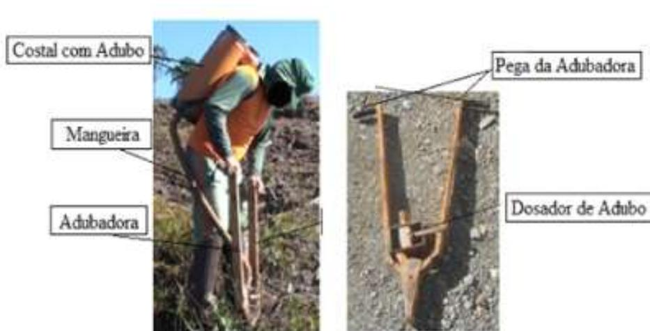
**Figura 3** Adubação manual, em detalhe adubadora tipo “catraca”
