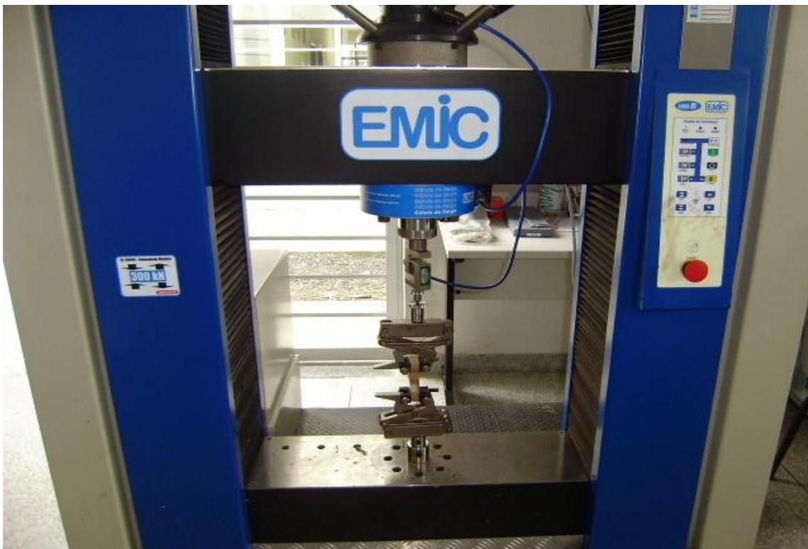
**Figura 8.** Ensaio de resistência ao esforço do cisalhamento na linha de cola.
