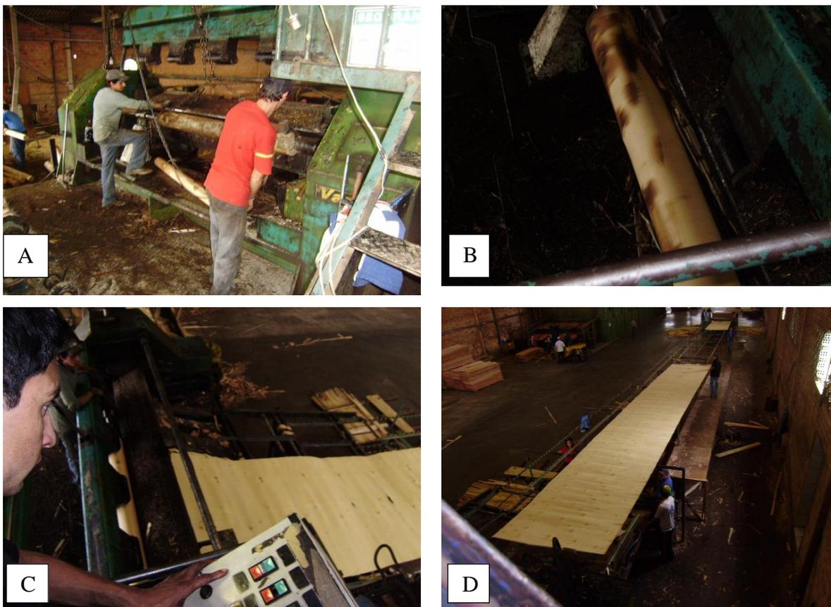
**Figura 1.** Laminação das toras. A) posicionamento da tora no torno; B) início da laminação; C) momento da laminação da tora; D) lâmina na esteira para guilhotinar.
