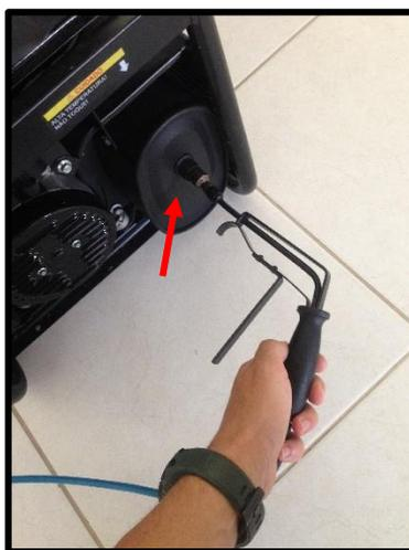
**Figura 3.** Sonda no analisador de gases inserida no escapamento do motor.
