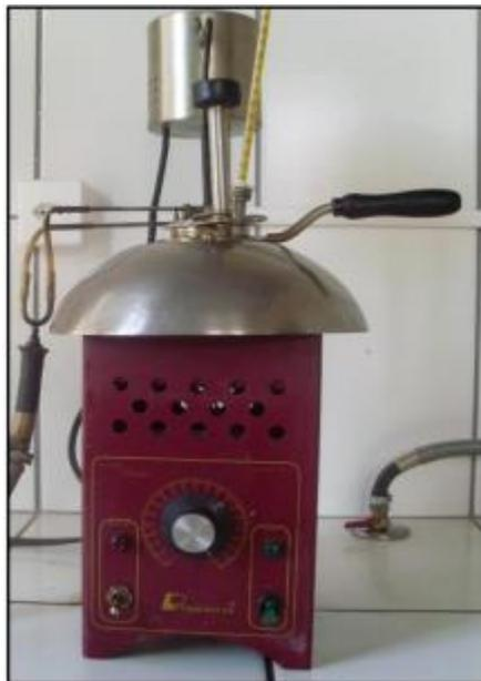
**Figura 19** - Aparelho utilizado para a medida de ponto de fulgor (GALLINA, 2011).
