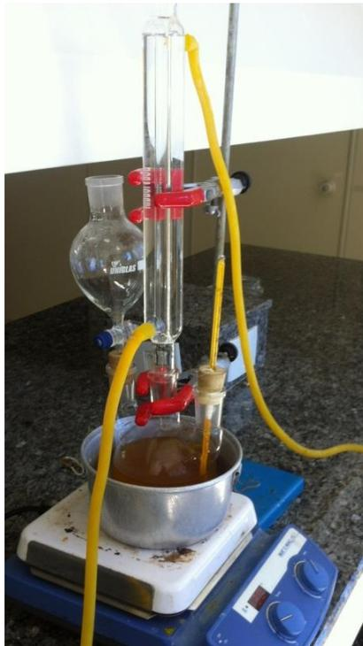
**Figura 18** – Aparato para a reação de transesterificação do biodiesel (Fonte próprio autor).
