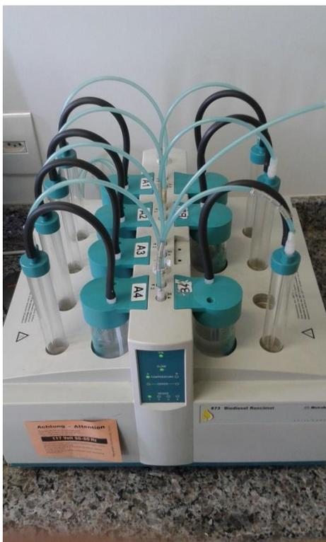
**Figura 13** - Equipamento 873 Biodiesel Rancimat – Metrohm®.
